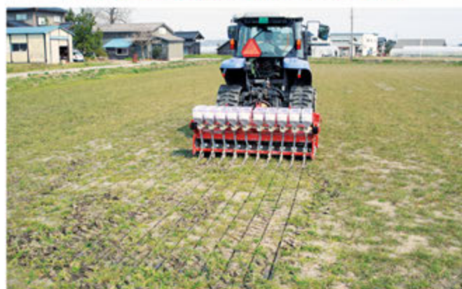
V字に溝を切る専用機械
