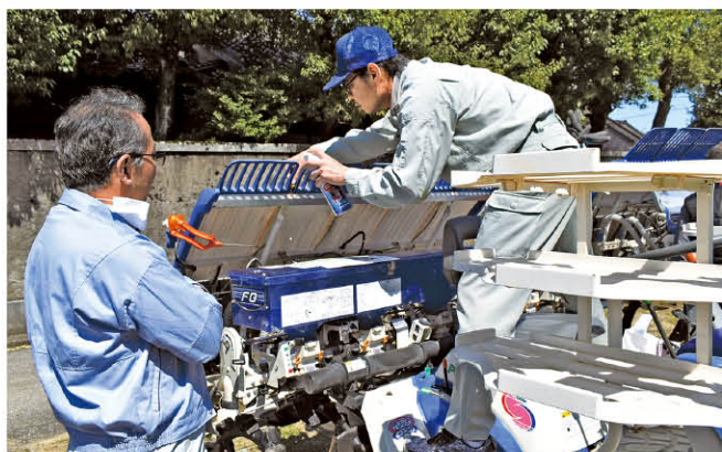
メンテナンスの注油作業
