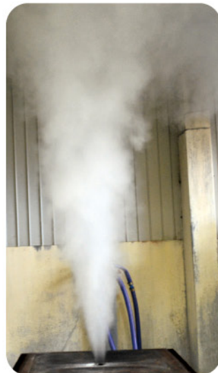
高圧の蒸気で20kgの米を10分で蒸す
